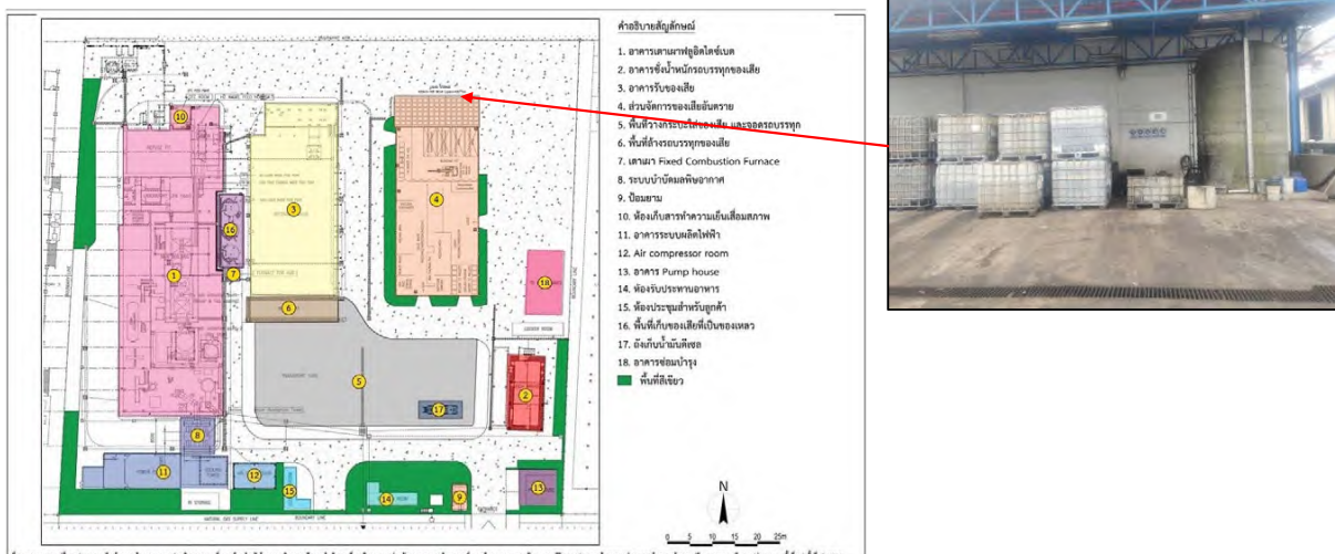
รูปที่ 5 พื้นที่เก็บรวบรวมน้ำเสียอันตรายในปัจจุบัน ซึ่งบรรจุในภาชนะที่เป็นถัง IBC ขนาด 1 ลูกบาศก์เมตร (ก่อนทำการเคลื่อนย้ายไปบิอนเข้าสู่เตาเผา)
